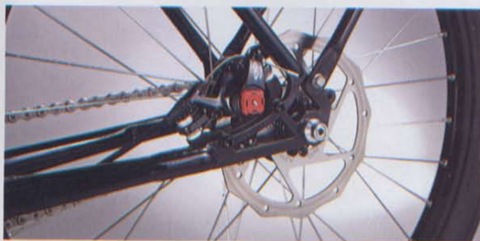
Eine ordentliche Verzögerung bei jeglicher Witterung gewährleistet die standfeste und fein dosierbare, mechanische Scheibenbremse von Avid.
