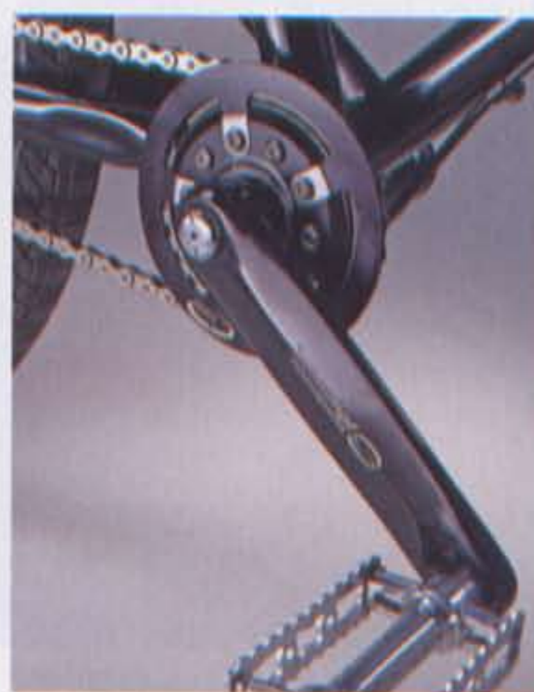
Die Schlumpf-Kurbel bietet zwei Gänge. Geschaltet wird per Druck der Ferse auf den silbernen Knopf.
