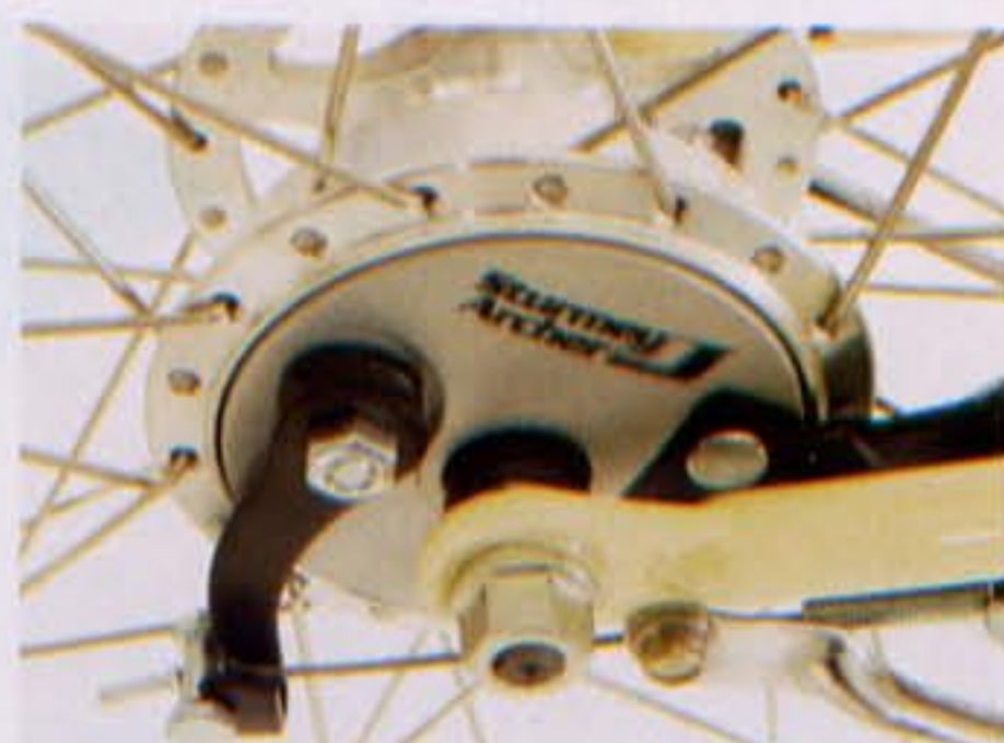
Eine Trommelbremse bringt sicher zum Stand
